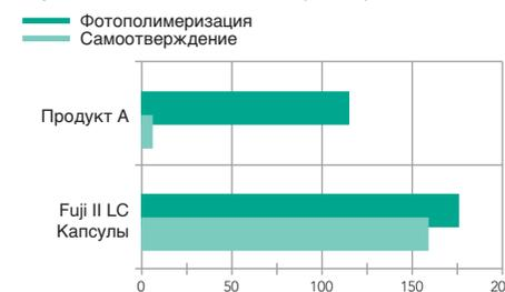
Fuji II LC показал высокую прочность на сжатие и при фотополимеризации, и при самоотверждении
